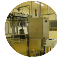
2 capsule fillers MG2 250 : 200 000 gélules/h Farmatic : 120 000 gélules/h
